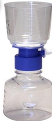
डीएनए के लिए रुचि क्षेत्र में बह जाने के बाद, फिल्टर के माध्यम से एकत्रित बफर घोल को डालें, फिल्टर को सील करें और विश्लेषण के लिए प्रयोगशाला में भेजें।
