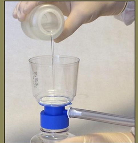
डीएनए के लिए रुचि क्षेत्र में बह जाने के बाद, फिल्टर के माध्यम से एकत्रित बफर घोल को डालें, फिल्टर को सील करें और विश्लेषण के लिए प्रयोगशाला में भेजें।
