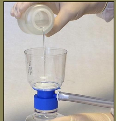
Nachdem die DNA des Untersuchungsbereichs eingesammelt wurde, gießen Sie die gesammelte Pufferlösung durch den Filter, versiegeln den Filter und senden das Ganze zur Analyse an das Labor.
